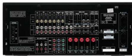
„Bessere“ Verstärker, hier das Modell AVR-7000 von Harman Kardon, bieten eine Leistung von 5 x 100 Watt RMS an 8 Ohm im 5-Kanal-Surround-Modus und eine Fülle von Anschlussmöglichkeiten
